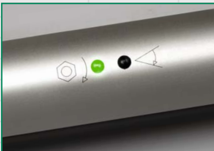
Farbige (RGB) Leuchtdioden an drei Seiten des Schlüssels gewährleisten zusätzlich zur kontinuierlichen Displayanzeige bessere Übersicht Coloured (RGB) diodes on three sides of the wrench provide additional security as well as the display
